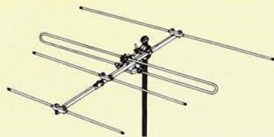
A sinistra: una antenna Yagi da installare sul tetto. Sopra: l'antenna amplificata AN 300 della Sony.
